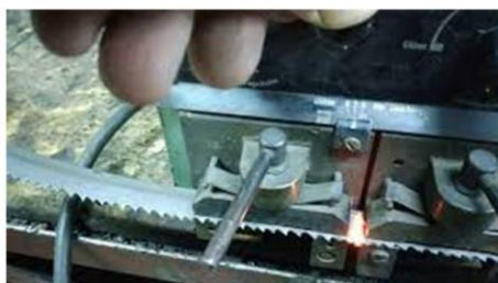
Čeono zavarivanje tračne testere sa ravnim završecima ploča
